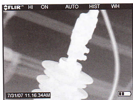
Рис. 4. Обнаружение утечки SF 6
